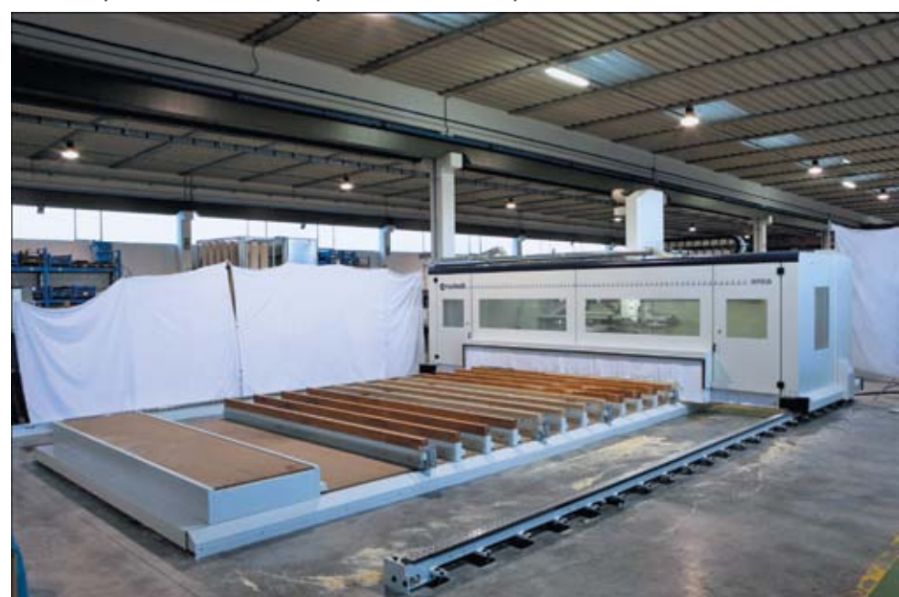
Рис. 2. Обрабатывающий центр с ЧПУ AREA для обработки плит CLT
