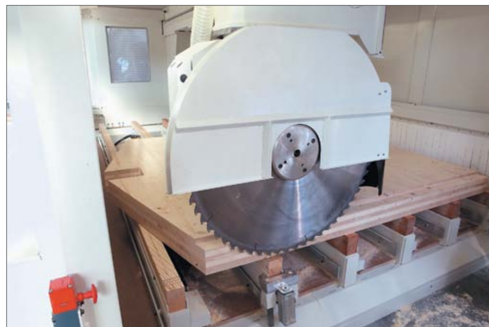
Рис. 3. Пятиосевой обрабатывающий агрегат Prisma-TLP мощностью 30 кВт с пыльным диском диаметром 1020 мм
