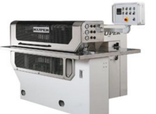
Станок для ребросклейивания делянок шпона встык на гладкую фугу
