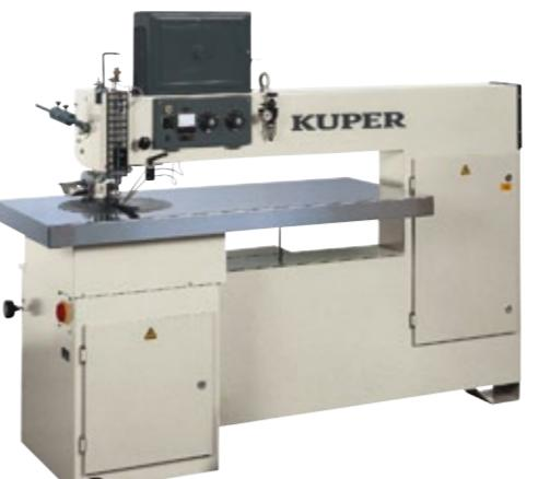
Станок для ребросклейивания шпона kleевой нитью
