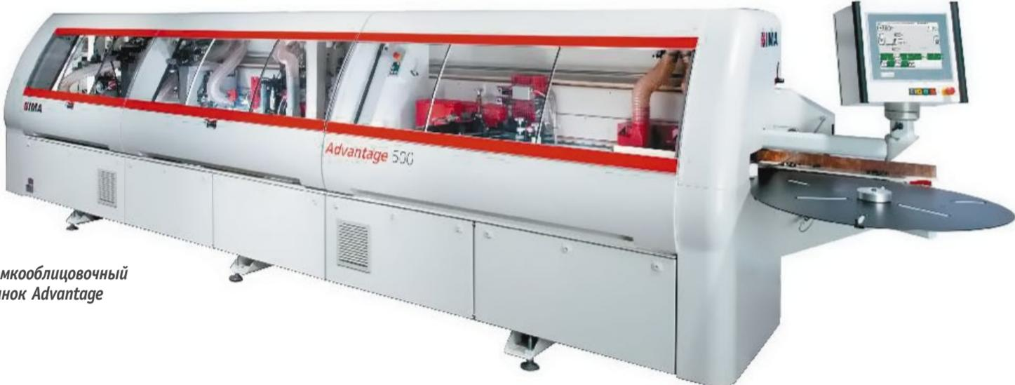
Кромкооблицовочный станок Advantage
