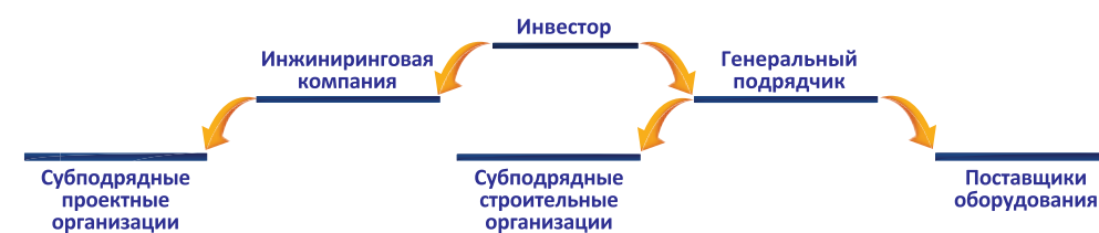
Рис. 1. Схема организации проекта при использовании метода подрядного строительства
