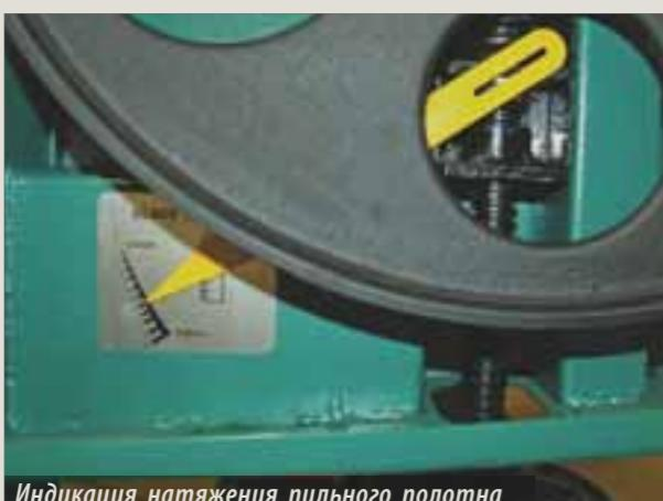
Индикация натяжения пильного полотна
