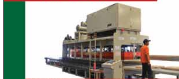
Высокочастотный пресс тяжёлой серии для производства клеёной древесины
