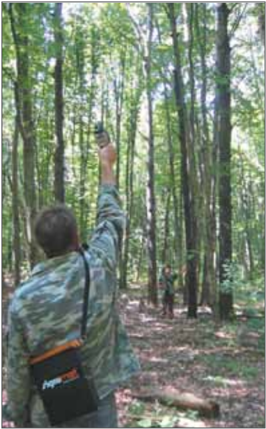
Рис. 13. Контрольные замеры высоты модельных деревьев высотомером
