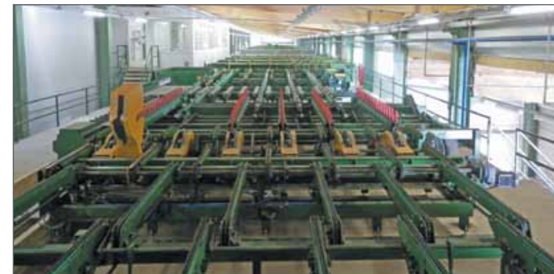
Установка сортировки досок перед вводом в эксплуатацию в РФ (сверху). Этажная сортировка на производстве клееного бруса из строганных ламелей (снизу)
