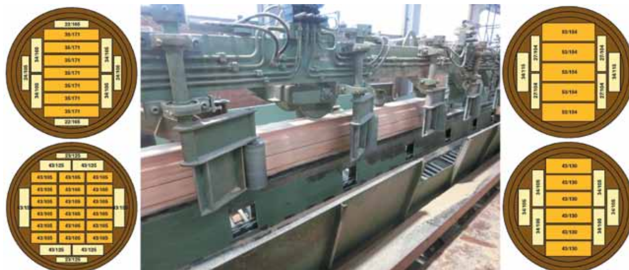
Профилирующая технология SAB: отделение боковых досок с лафета
