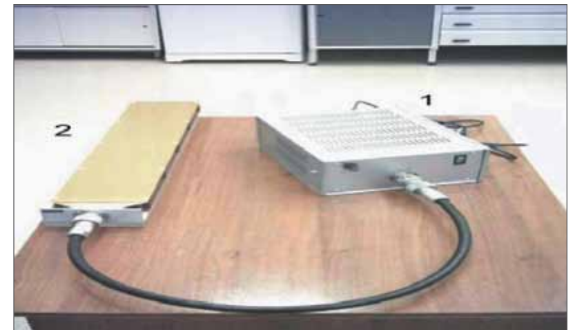
Рис. 1. Установка предпосевной обработки семян импульсным электрическим полем: 1 – генератор высоковольтного импульсного напряжения; 2 – плоский волновод с высокоомной нагрузкой
