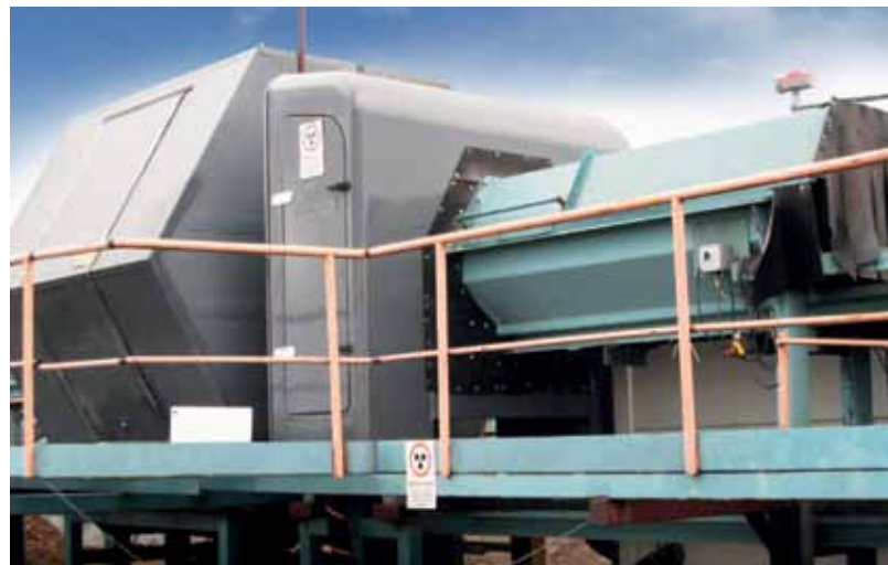
Рис. 6. Рентгенографическая установка для определения внутреннего строения пиловочных бревен (Limab)
