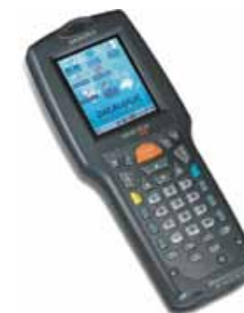
Рис. 1. Мобильный защищенный терминал сбора данных с модулем Bluetooth
