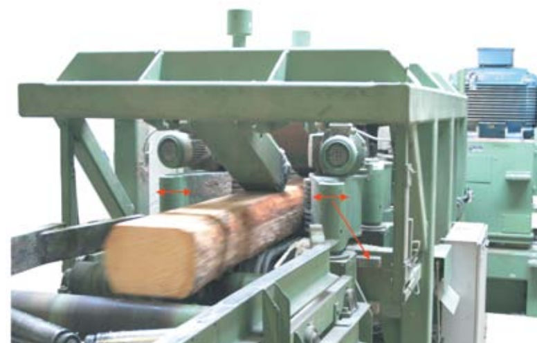
Оптимизация выхода 2: Перед вторым фрезерно-брусующим станком лафет не просто центрируется, а поворачивается в оптимальное положение на основе данных трехмерного измерения.
