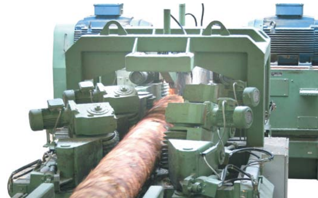
Оптимизация выхода 1: Перед первым фрезерно-брусующим станком бревно, прошедшее трехмерное сканирование, поворачивается в положение, оптимальное для запрограммированной схемы раскроя.
