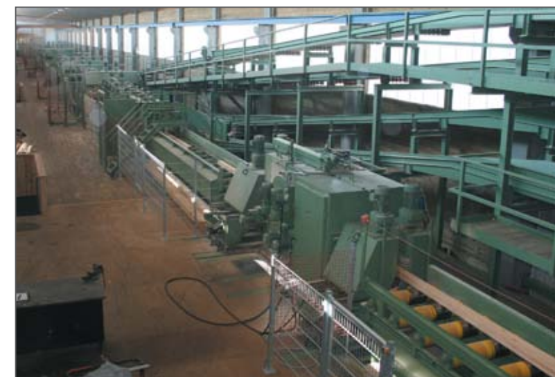
Оптимизация выхода 3: Отвод боковых досок на установку сортировки пиломатериала: на линии SAB в Хагенове возможна распиловка до 8 боковых досок с оптимизацией их положения, до 12 при использовании делительной пилы для боковой доски.
