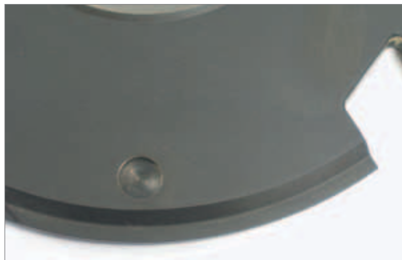
Рис. 7. Высверленный материал во время балансировки
