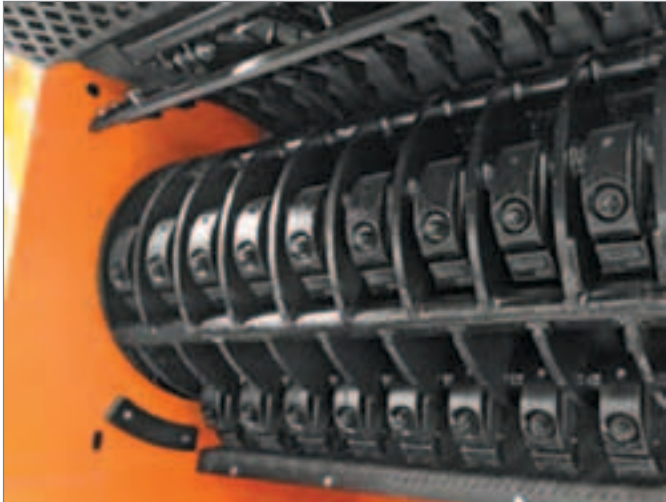
Ротор молоткового измельчителя Doppstadt AK-серии
