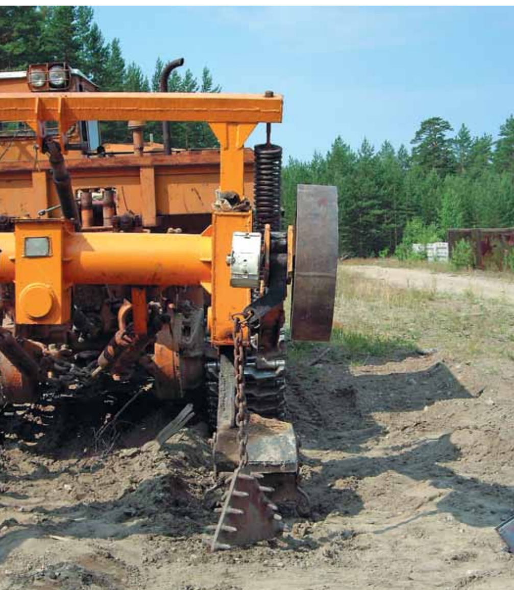
Рис. 2. Секция высевального приспособления к лункообразователю Л-2У
