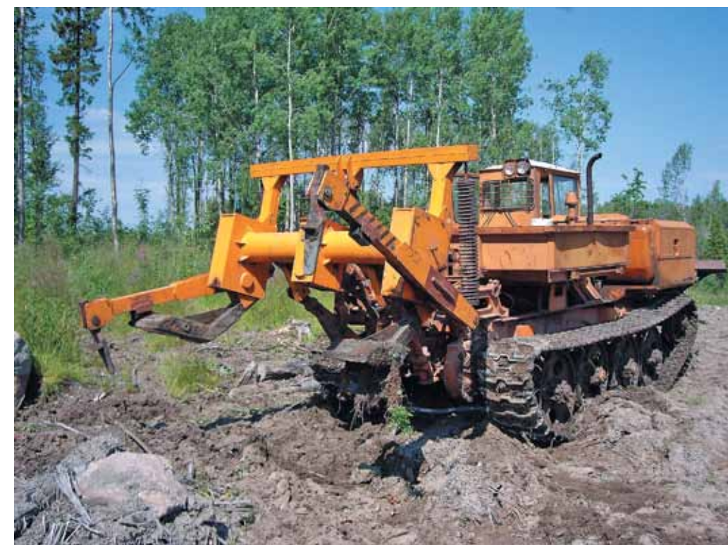
Рис. 1. Лункообразователь Л-2У, агрегатированный с трактором ЛХТ-55
