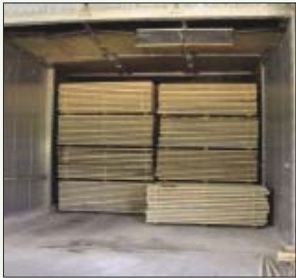
Сушильные камеры с фронтальной загрузкой оснащены подъемно-сдвижными воротами
