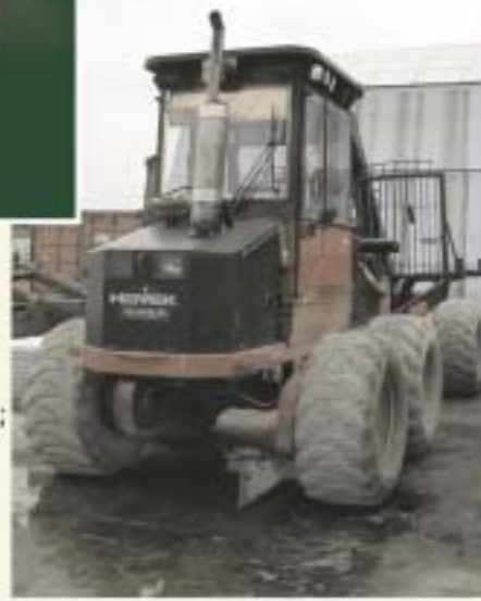
ФОРВАРДЕР HEMEK CICERON TD81 (в СП6); 8WD; 1994 г.; грузопод. 12 т.; наработка 13500 м³; 50 тыс. евро
