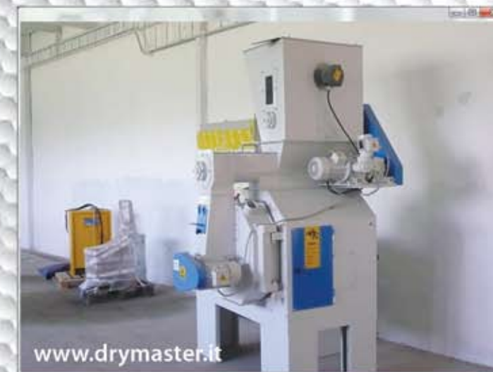
Тип: Пресс по изготовлению пеллет Фирма: МТС, Италия Детали: 300 м³/час
