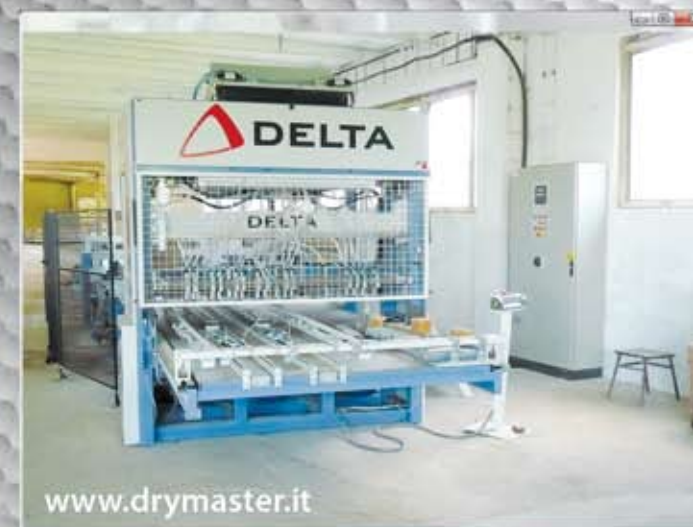
Тип: Линия по изготовлению поддонов Фирма: DELTA, Италия Детали: 500-600 палет в смену
