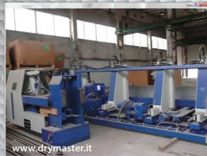
Тип: Вертикальная ленточная пиломорама Фирма: ARTIGLIO, Италия Детали: Модель 1150 с гидравлической кареткой
