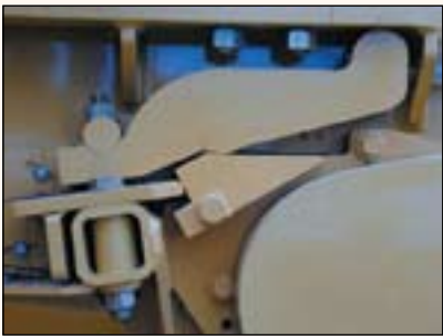
Упорная плита обеспечивает минимальный износ деталей в области измельчения
