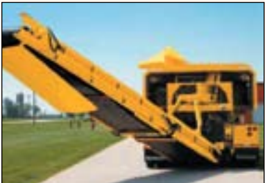
Дробилка TG9000: оператор может управлять направлением выброса, разгрузочный конвейер поворачивается в пределах 60°
