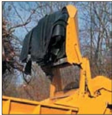
Горизонтальная дробилка: ограничитель вылета препятствует заторам при загрузке длинных стволов
