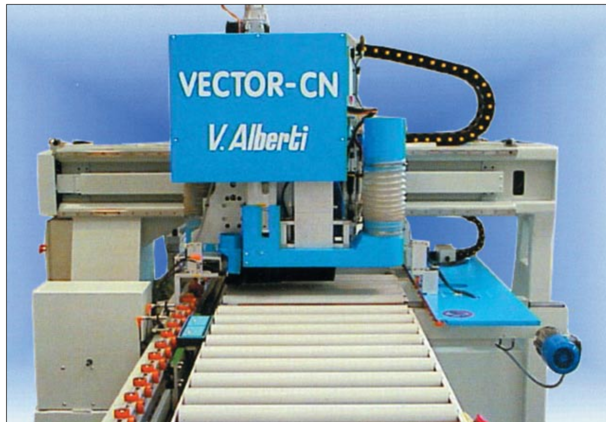
Рис. 6. Станок сверлильно-присадочный с продольной подачей деталей
