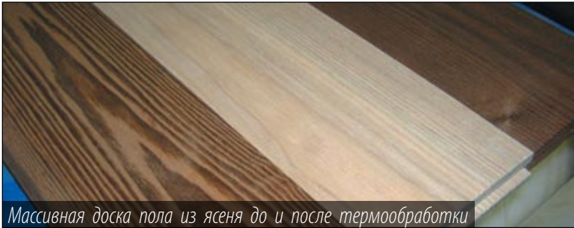
Массивная доска пола из ясеня до и после термообработки
