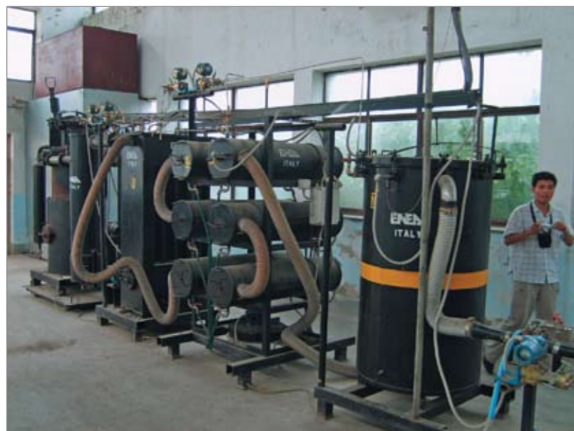
Рис. 5. Газогенераторная установка ENEA силовой мощностью 80 кВт (производство – Италия), работающая на отходах древесной биомассы влажностью до 30%
