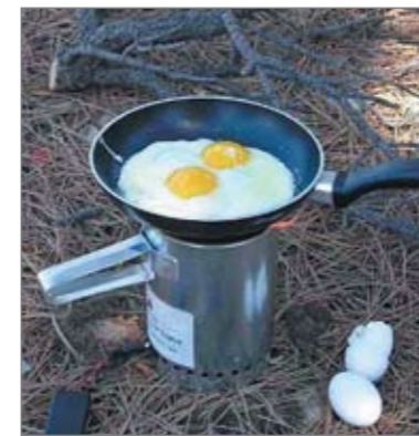
Рис. 15. Переносная газогенераторная установка тепловой мощностью 2,4 кВт, работающая на растительных и древесных отходах биомассы влажностью до 40% и предназначенная для приготовления пищи в походных условиях
