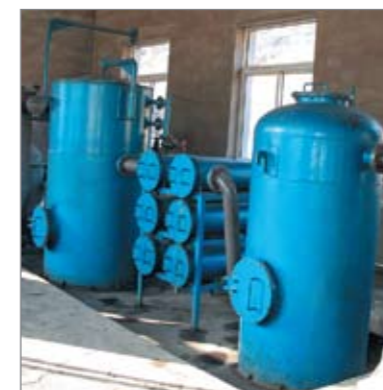
Рис. 11. Газогенераторная установка мощностью 300 кВт, работающая на сельскохозяйственных растительных отходах влажностью до 40%
