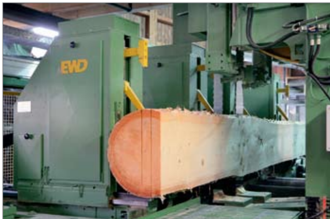
Рис. 1. Ленточно-пильные станки конфигурации «tандем»
