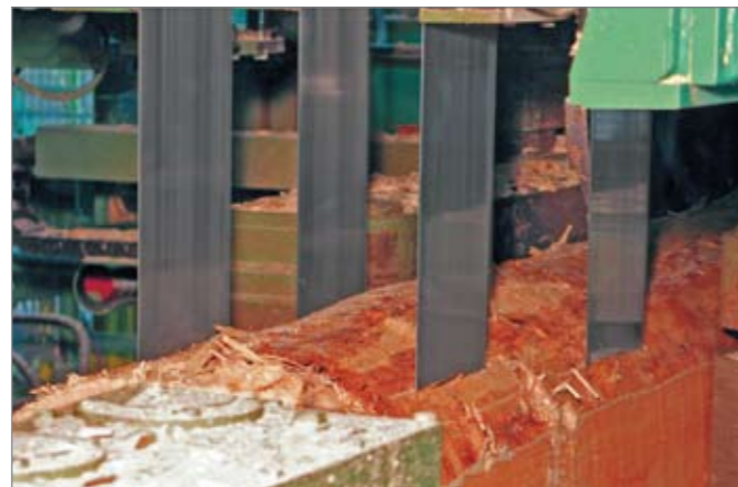
Рис. 2. Пример распиловки бревен на первом проходе при помощи счетверенных ленточно-пильных станков
