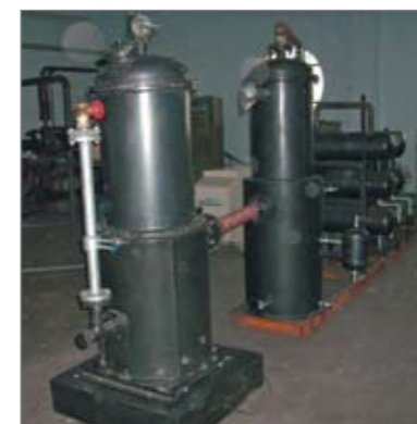
Рис. 11. Газогенераторная установка мощностью 300 кВт, работающая на сельскохозяйственных растительных отходах влажностью до 40%
