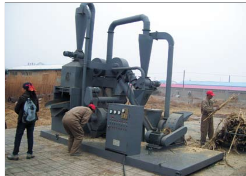
Рис. 14. Установка для пеллетирования сельскохозяйственных растительных отходов, изготовленная Ляонинским институтом энергетических ресурсов, производительностью 250 кг/час
