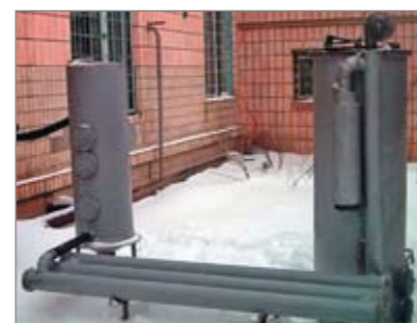
Рис. 7. Газогенераторная установка тепловой мощностью 100 кВт (производство – украинская фирма «АТТИК»), работающая на отходах древесной биомассы влажностью до 45%
