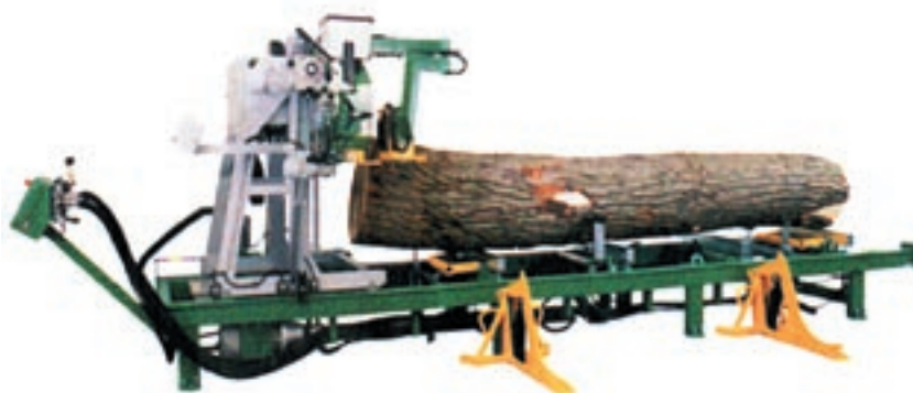
Рис. 1. Горизонтальный ленточно-пильный станок позиционного типа
