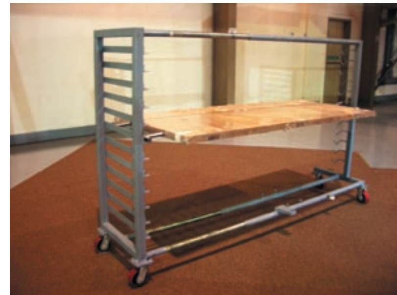
Фото 2. Тележка-этажерка с 12 этажами для сушки покрытий (дверное полотно закреплено вспомогательными скобами)
