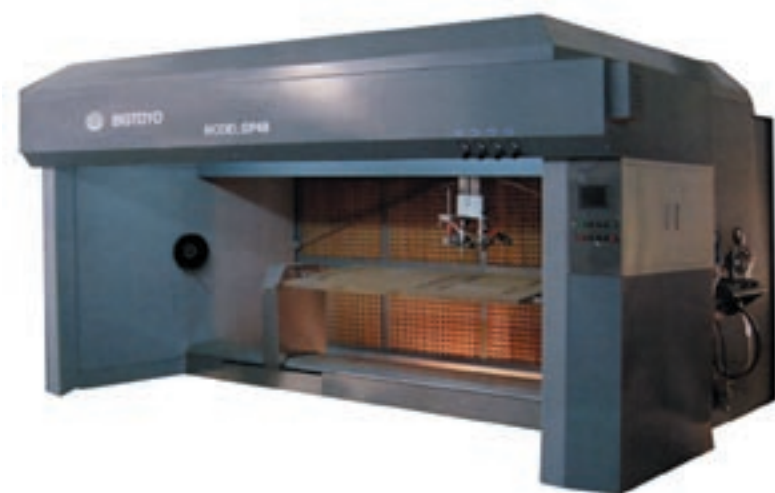
Фото 1. Установка для автоматического нанесения отделочных материалов на обе пласти и продольные кромки дверного полотна мод. AD-48
