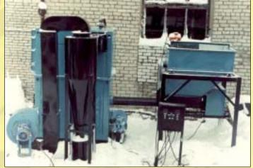
руется с пульта управления. При выходе из строя автоматики или в других случаях предусмотрена загрузка вручную через топочную дверь. Предусмотрена возможность использования дров и кусковых отходов.
