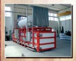
В пресс-вакуумных камерах воплошены самые передовые методы сушки древесины, которые позволяют производить сушку древесины в 8-10 раз быстрее, чем в традиционных сушилках. Помимо вакуума используется эффект давления на штабель с усилием до 10 000 кг/м², которое создается с помошью специальной мембраны. Доска в процессе сушки не деформируется, а выравнивается, уменьшая количество бракованной продукции. Данное преимущество особенно очевидно при работе с ценными породами древесины.
