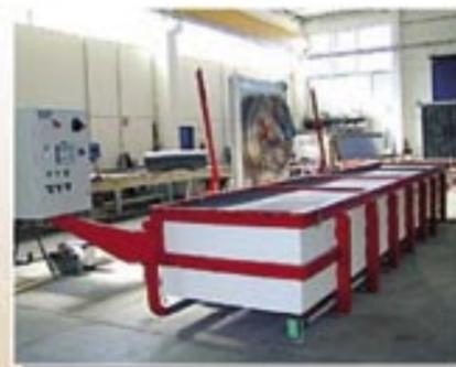
В пресс-вакуумных камерах воплощены самые передовые методы сушки древесины, которые позволяют производить сушку древесины в 8-10 раз быстрее, чем в традиционных сушилах. Помимо вакуума используется эффект давления на штабель с усилием до 10 000 кг/м<sup>2</sup>, которое создается с помощью специальной мембраны. Доска в процессе сушки не деформируется, а выравнивается, уменьшая количество бракованной продукции. Данное преимущество особенно очевидно при работе с ценными породами древесины.
