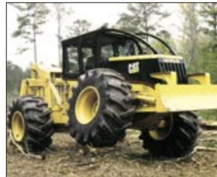
Рис.7 Скиддер Caterpillar с качающимся передним мостом
