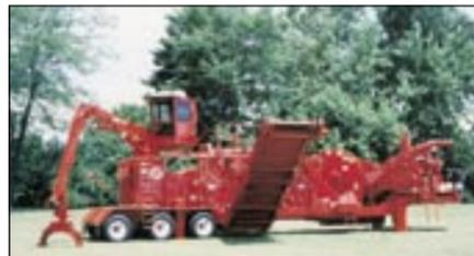
Модель 2755 сочетает в себе проверенную временем технологию производства щепы на деляне с последними достижениями в области окоривания.
