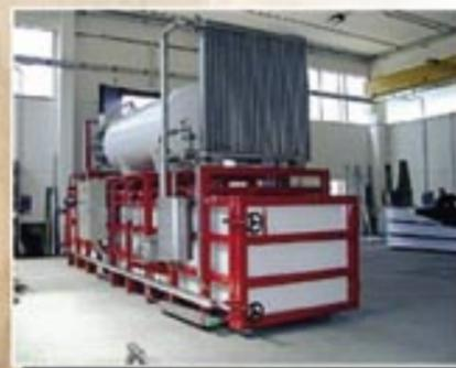
Объем камер от 0.3 до 10 м<sup>3</sup> позволяет их использовать как на крупных заводах, так и на предприятиях с небольшим суточным объемом переработки. Кроме того, пресс-вакуумные камеры занимают немного места, не нуждаются в фундаменте и расходуют меньше тепла, электроэнергии.
